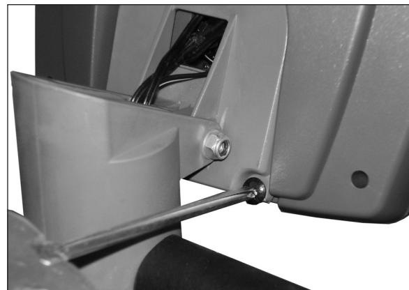
Liitä runkoputkesta tuleva johto käsitukiputken alapäässä olevaan liittimeen. Varmista liitoksen lukitus nykäisemällä johtoa kevyesti. Ohjaa liitetty johto huolellisesti runkoputken sisään ja työnnä käsitukiputki paikalleen runkoputken sisään sitten, että kiinnitysruuvien kannat jäävät laitteen etupuolelle.
