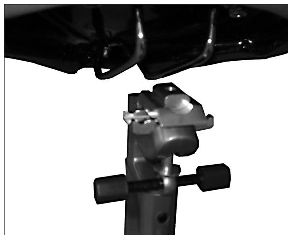
Lossa låsskruven till sitshållaren och vrid den övre låsspaken så att den är i linje med utrustningen. Placera sitsen på räfflorna på den nedre låsspaken. Vrid den övre låsspaken mot den övre delen av sitsspåren och lås sitsen genom att dra åt låsskruven.
