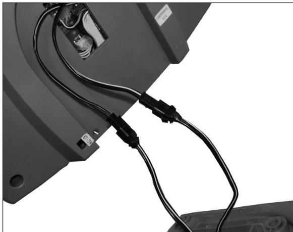
Collegare i cavi del manubrio ai connettori corrispondenti sul pannello. Inserire i cavi collegati nel pannello, verificando che non siano danneggiati una volta che il pannello è collegato. Collocare il pannello in posizione all'estremità del tubo di supporto del manubrio e fissarlo utilizzando due viti.
