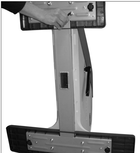
Fassen Sie den Sitz des Geräts, und neigen Sie es nach hinten, damit es auf den Transportrollen aufsitzt. Befestigen Sie die hintere Stütze von unten mit vier Inbussechskantschrauben und Unterlegscheiben. Befestigen Sie die vordere Stütze mit vier Schrauben und Unterlegscheiben am Rahmen. Bringen Sie das Gerät in die aufrechte Position zurück, damit es auf den Stützfüßen steht.
