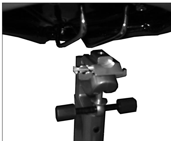
Desserrez la vis de blocage du support de la selle, puis tournez le levier de verrouillage supérieur afin de l'aligner avec l'équipement. Mettez le siège en place dans les rainures du levier de verrouillage inférieur. Tournez le levier de verrouillage supérieur vers le haut des rails de guidage du siège, puis fixez le siège en serrant la vis de blocage.
