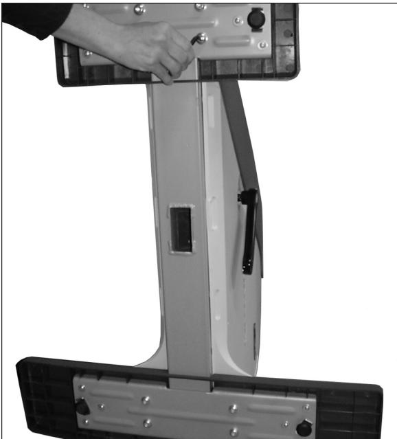
Håll fast sätet samtidigt som du lutar utrustningen bakåt tills den lutar mot transportsjälven. Fäst det bakre stödet underifrån med fyra insexskruvar och brickor. Fäst det främre stödet till ramen med hjälp av fyra skruvar och brickor. Ställ tillbaka utrustningen i upprätt läge så att den vilar på stödfötterna.
