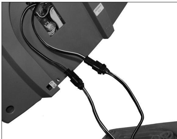
Verbinden Sie die Kabel vom Lenkerbügel mit den entsprechenden Anschlüssen am Cockpit. Führen Sie die verbundenen Kabel in das Cockpit ein. Achten Sie darauf, dass sie beim Anschließen des Cockpits nicht beschädigt werden. Bringen Sie das Cockpit am Ende der Lenkerbügelpfosten an, und befestigen Sie es mit zwei Halterungsschrauben.
