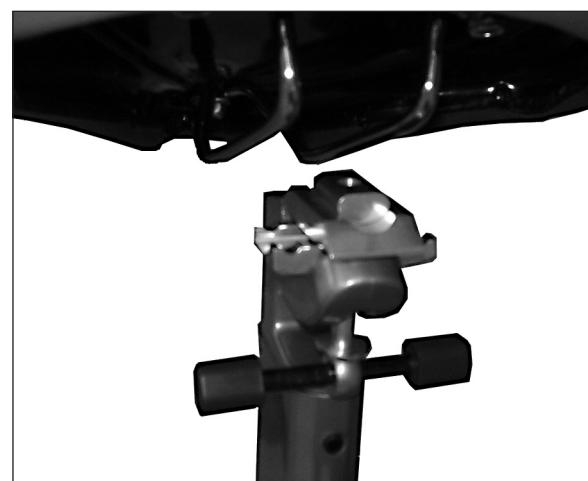
Aflojar el tornillo de bloqueo del soporte del asiento y girar la palanca superior de bloqueo hasta que quede alineada con la máquina. Colocar el asiento en su posición en las ranuras de la palanca inferior de bloqueo. Girar la palanca superior de bloqueo hacia la parte de arriba de las guías del asiento y bloquear éste apretando el tornillo de bloqueo.
