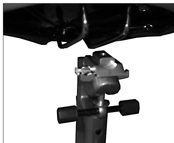
Lösen Sie die Feststellschraube des Sattelhalters, und drehen Sie den oberen Feststellhebel so, dass er auf das Gerät ausgerichtet ist. Führen Sie den Sattel in die Nuten des unteren Feststellhebels. Drehen Sie den oberen Feststellhebel zur Oberseite der Sattelschienen, und arretieren Sie den Sattel, indem Sie die Feststellschraube anziehen.
