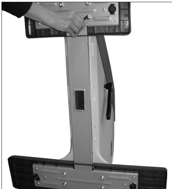
Trek door het zadel vast te houden het apparaat naar achteren, zodat het op zijn transportwieltjes rust. Bevestig de achtersteun vanaf onderen met vier binnenzeskantschroeven en sluitringen. Bevestig de voorsteun aan het frame met vier schroeven en sluitringen. Zet het apparaat weer rechtovereind zodat het op de steunvoeten rust.
