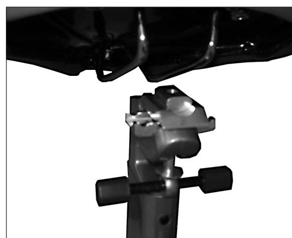
Allentare la vite di bloccaggio del supporto del sedile e ruotare la leva di bloccaggio superiore fino ad allinearla con l'attrezzo. Inserire il sedile in posizione lungo le scanalature della leva di bloccaggio inferiore. Ruotare la leva di bloccaggio superiore in direzione dei binari del sedile e bloccare il sedile serrando la vite di bloccaggio.
