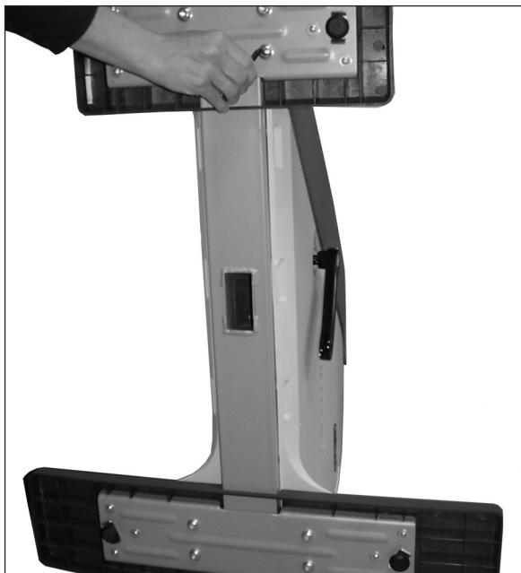
Sujetando por el sillín, inclinar la bicicleta hacia atrás de modo que repose sobre las ruedas de transporte. Montar el soporte trasero desde abajo con los cuatro tornillos Allen y arandelas. Acoplar el soporte delantero al cuadro con cuatro tornillos y arandelas. Devolver la bicicleta a su posición erecta de modo que descance sobre las patas de soporte.
