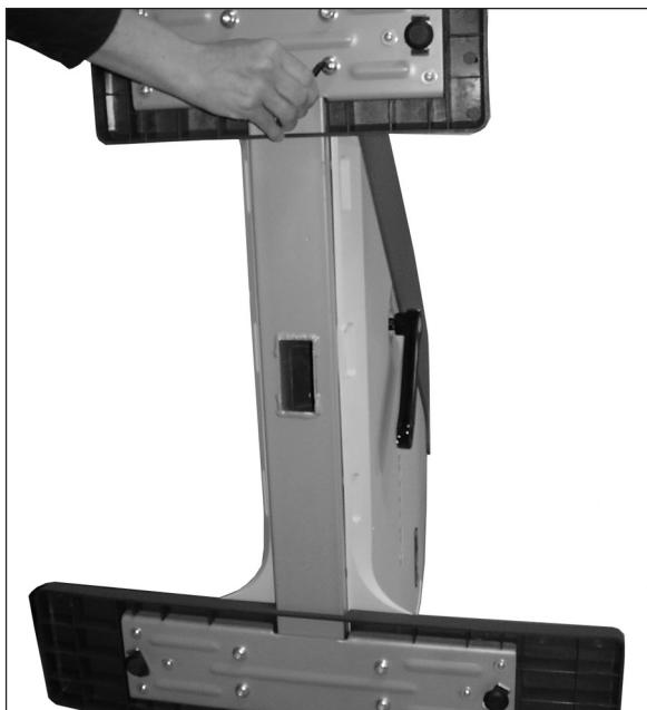
Kallistakaa laitetta taaksepäin siirtopyörien varaan istuimesta kiinni pitäen. Kiinnitää takatukijalka altapäin neljällä kuusiokoloruuvilla ja aluslaatalla. Kiinnitää etutukijalka runkoon neljällä ruuvilla ja aluslaatalla. Kallistakaa laite takaisin pystyasentoon tukijalkojen varaan.
