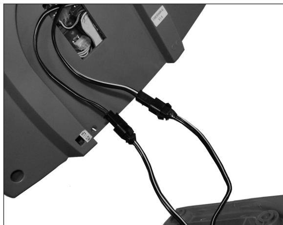
Verbind de kabels van de stuurstang naar de corresponderende aansluitingen van de monitor. Steek de aangesloten kabels in de monitor, maar zorg ervoor dat ze niet beschadigd raken als de monitor wordt bevestigd. Plaats de monitor aan het uiteinde van de steunbus van de stuurstang en zet hem met twee bevestigingsschroeven vast.
